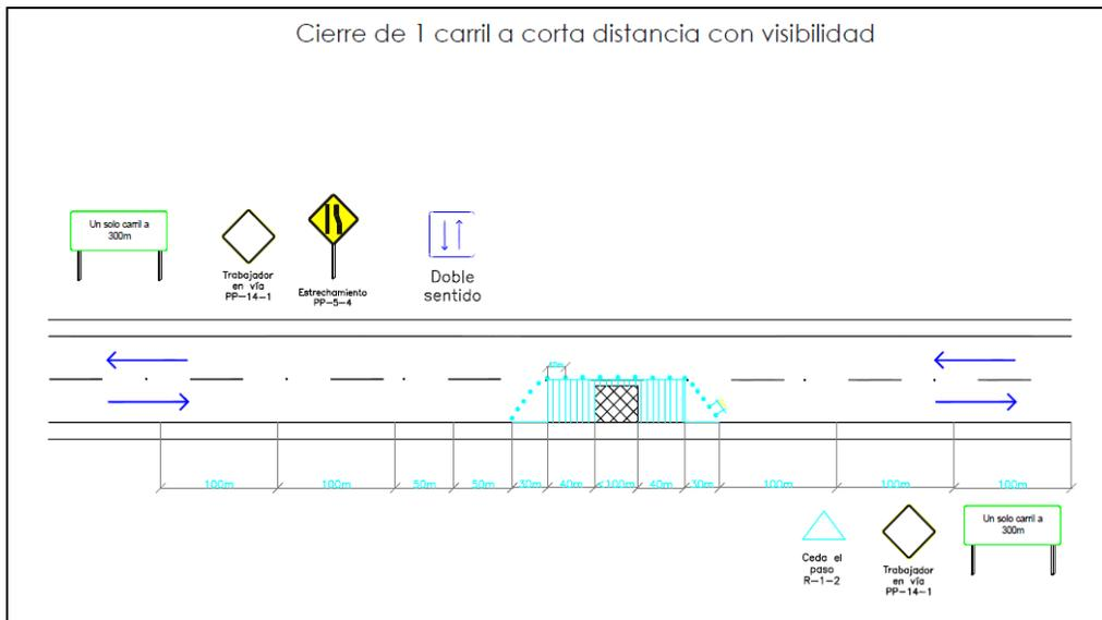
**Figura N° 4.** Esquema Cierre de 1 carril a corta distancia con visibilidad
