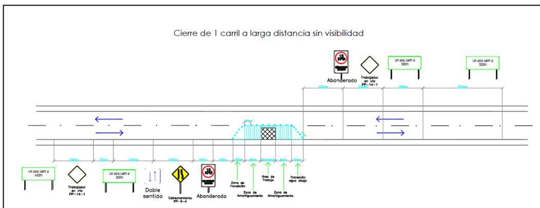
**Figura N° 5.** Esquema Cierre de 1 carril a larga distancia sin visibilidad.
