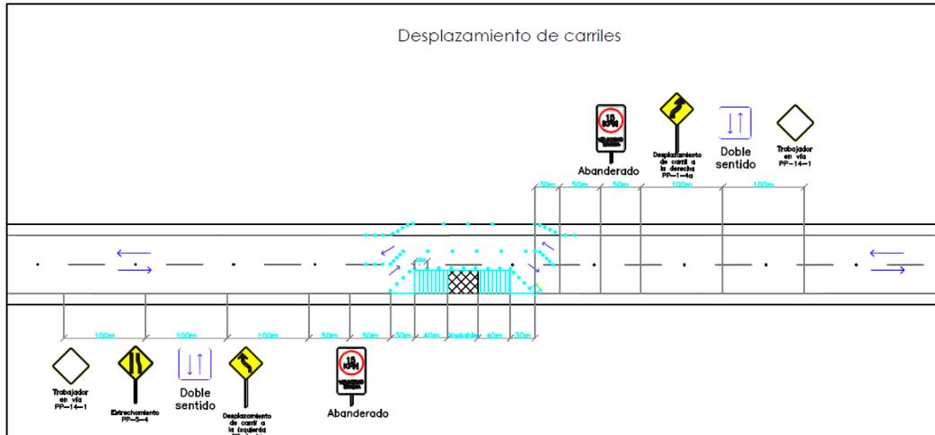
**Figura N° 6.** Esquema Desplazamiento de carriles.
