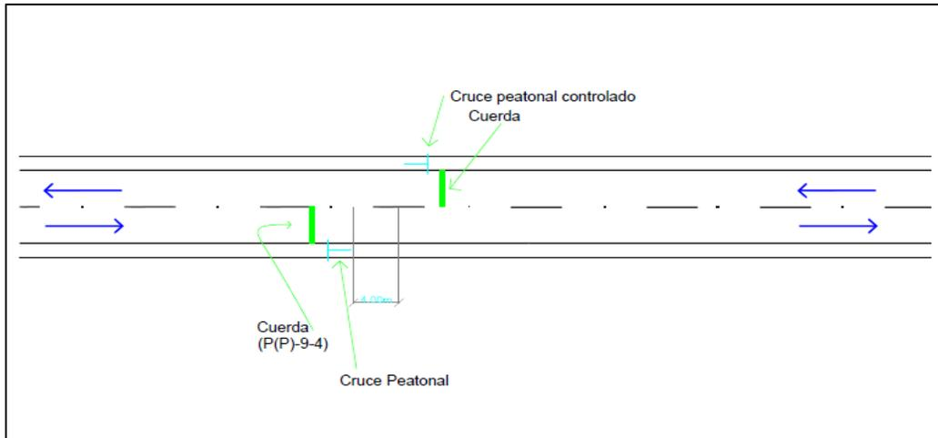
**Figura N° 2.** Esquema Cruce peatonal Controlado.
