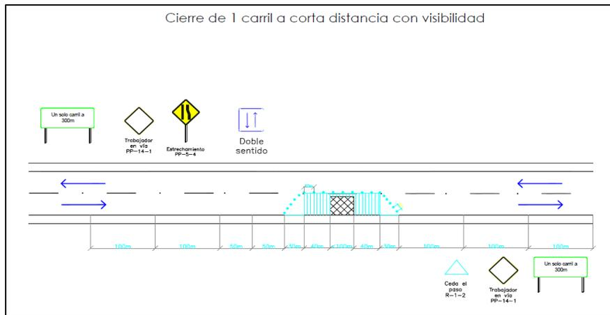
**Figura N° 4.** Esquema Cierre de 1 carril a corta distancia con visibilidad
