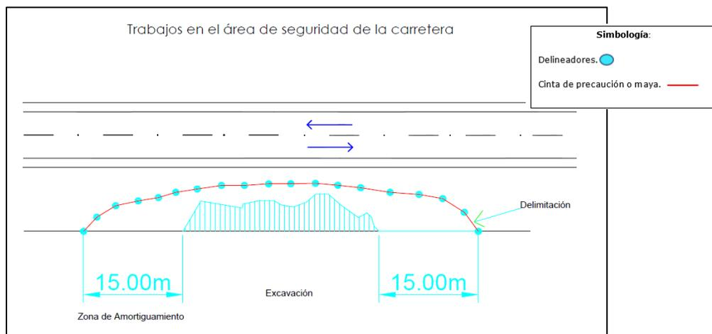
**Figura N° 3.** Esquema Trabajos en el área de seguridad de la carretera
