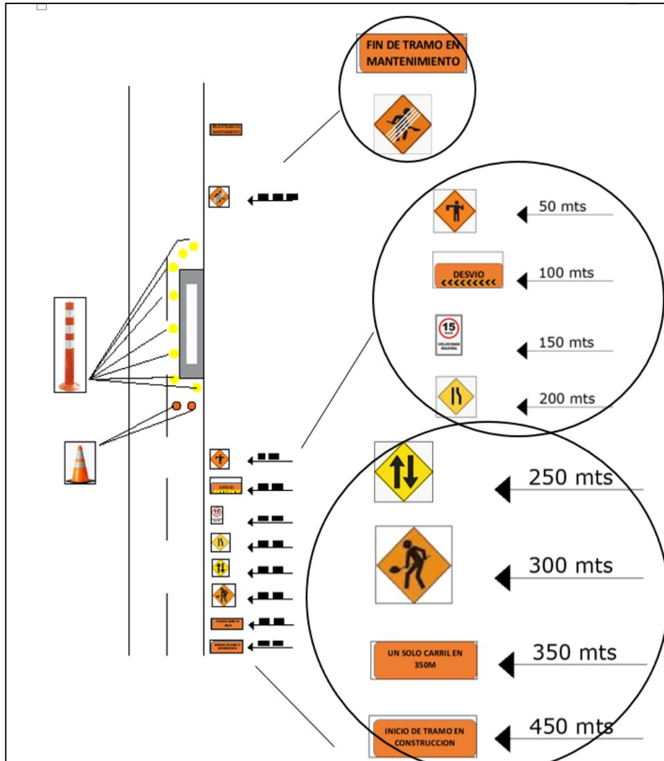
**Figura 10.** Señalización Obras de Drenaje
