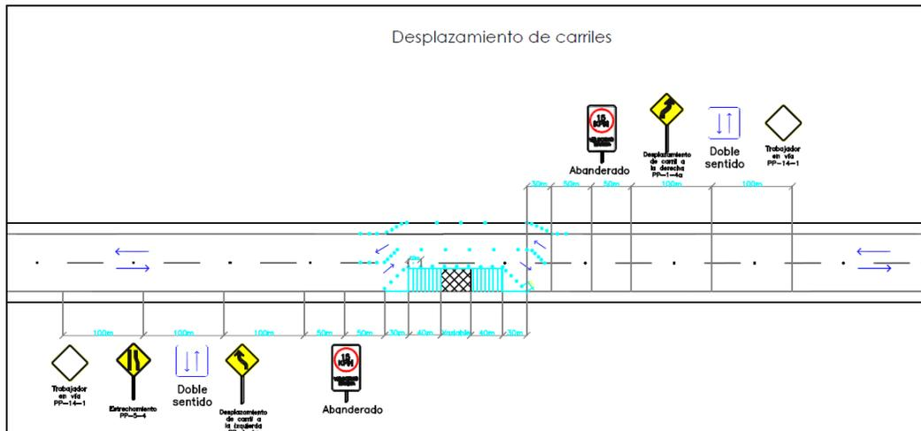
**Figura N° 6.** Esquema Desplazamiento de carriles.
