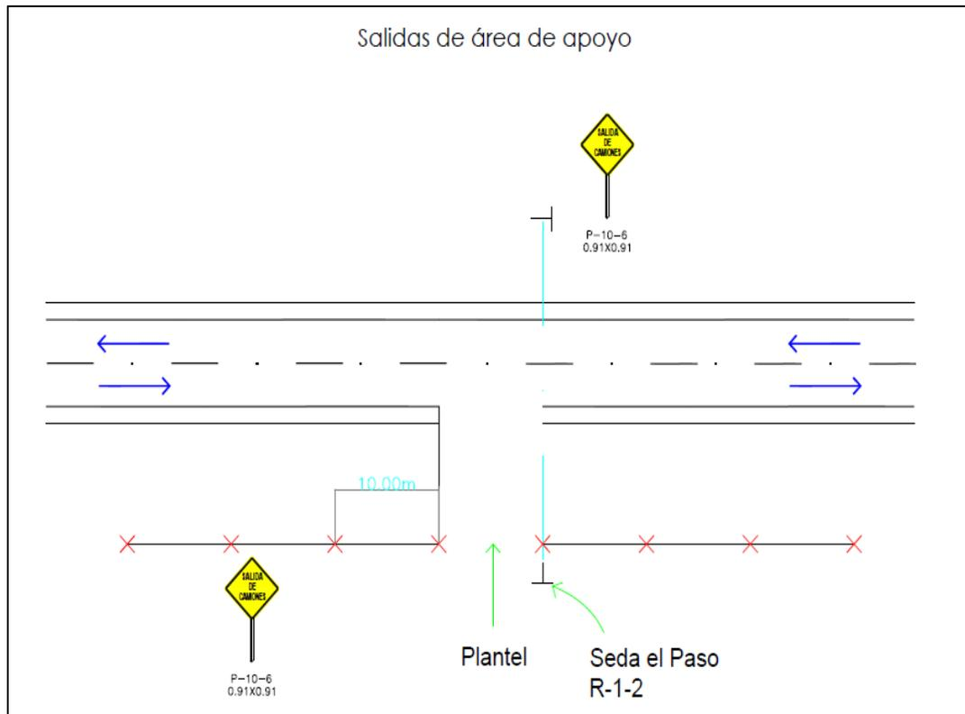
**Figura N° 1.** Esquema salidas áreas de apoyo.
