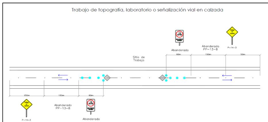
**Figura N° 7.** Esquema Trabajo de topografía, laboratorio o señalización vial en calzada.
