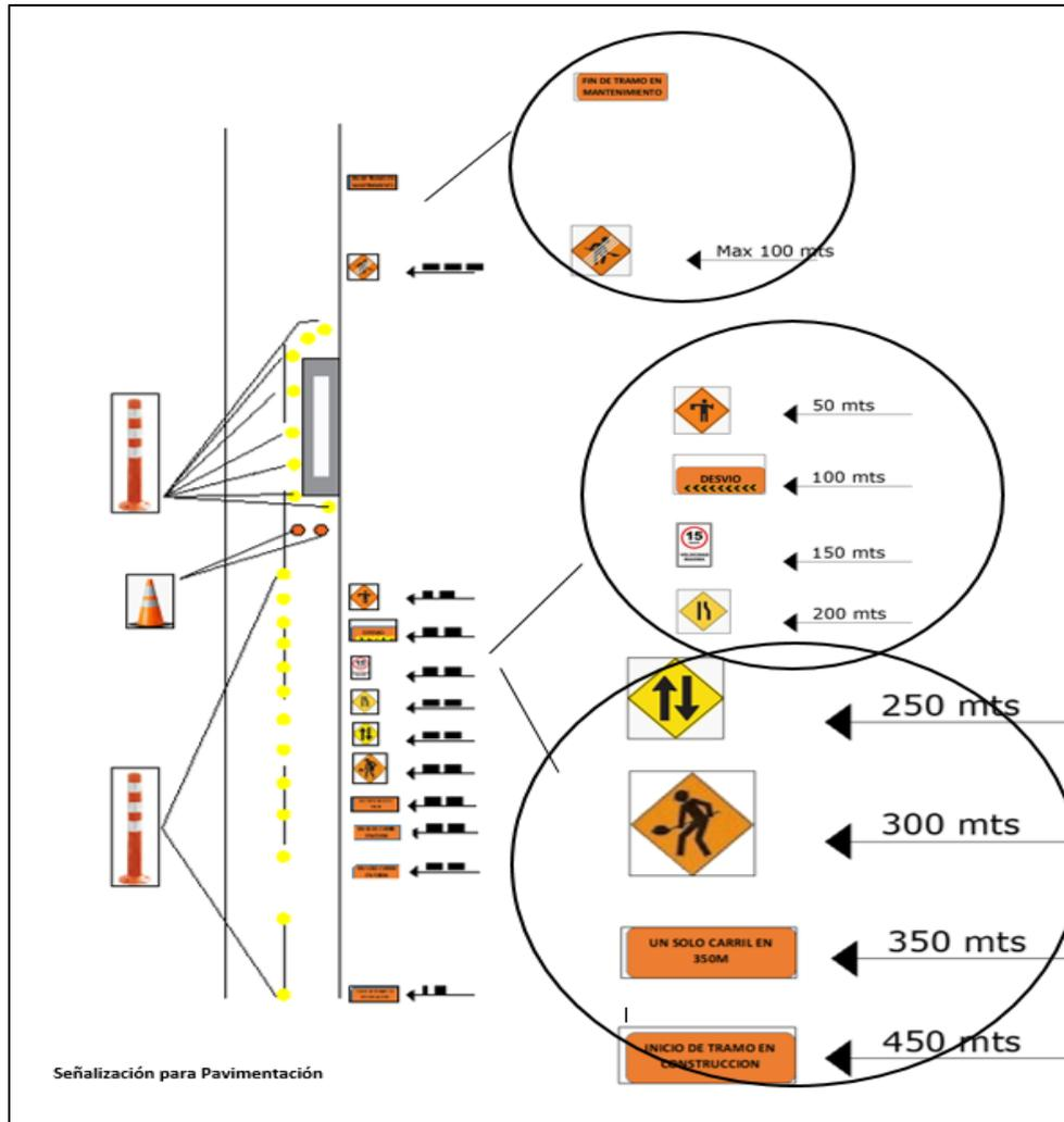
**Figura 9.** Señalización para pavimentación.
