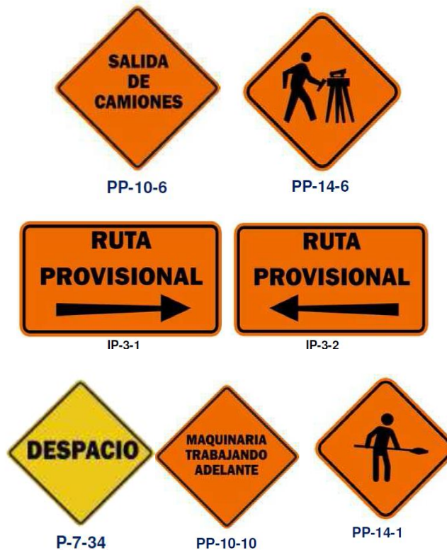
Ilustración 44. rótulos viales provisionales.
