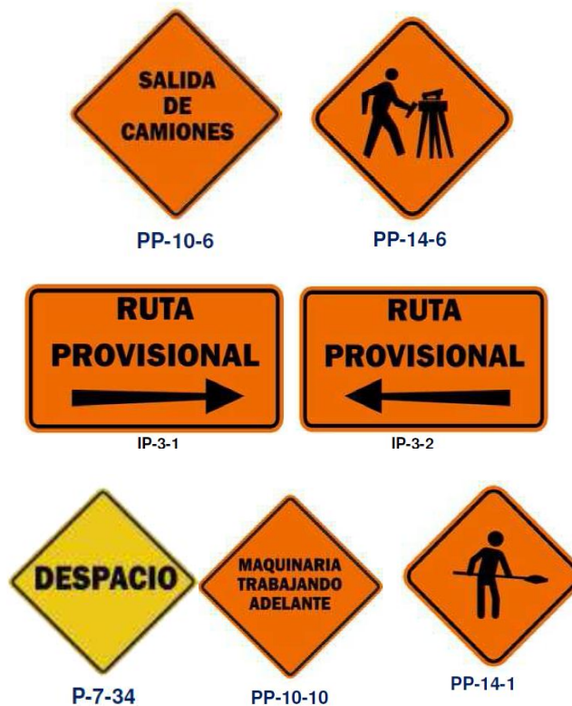
Ilustración 39. rótulos viales provisionales.
