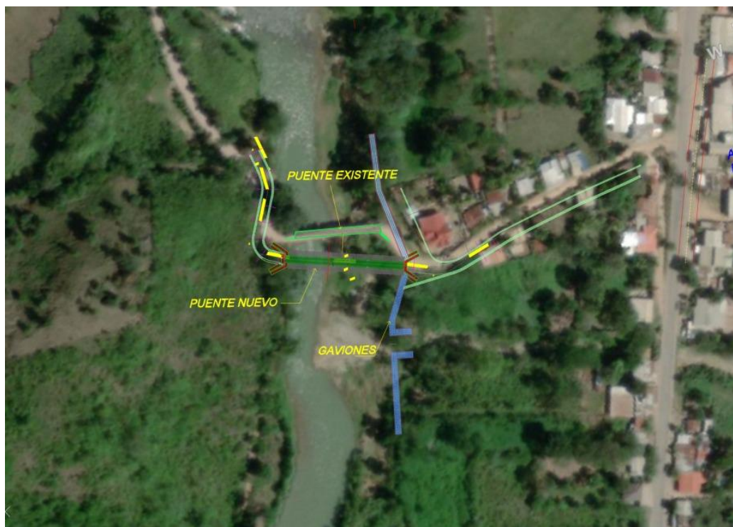
Ilustración 14. Ubicación del puente actual que será paso provisional y la nueva ubicación del puente a construirse.
